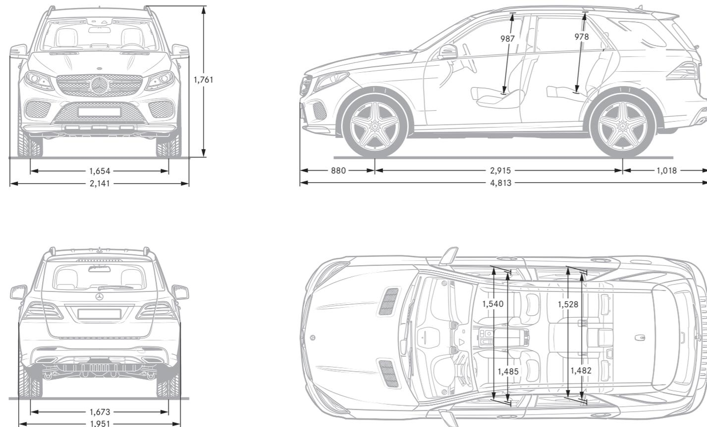
\*所有测量值均以“毫米”为单位。所示尺寸为平均值, 适用于空载的标准车型。
