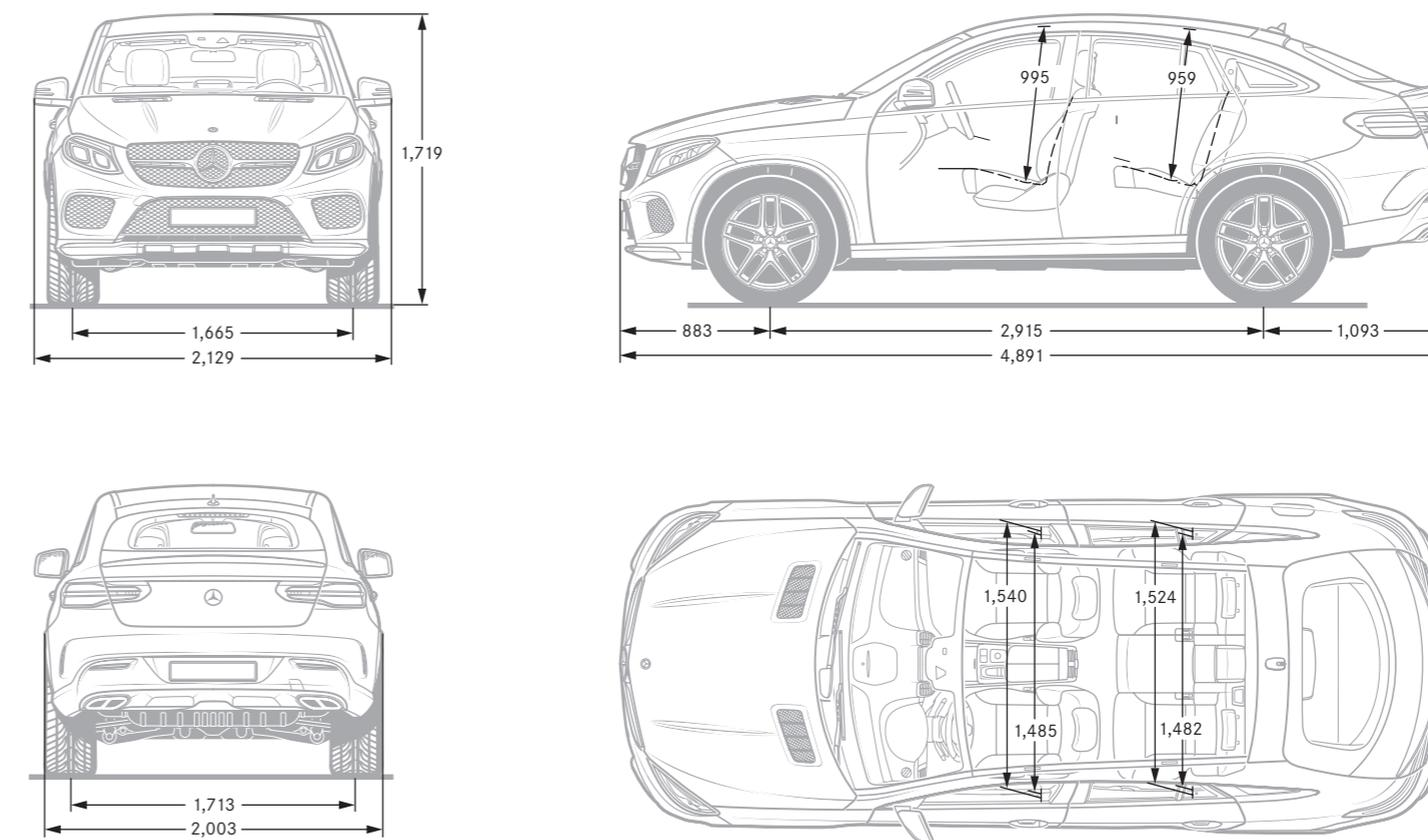
\*所有测量值均以“毫米”为单位。所示尺寸为平均值, 适用于空载的标准车型。
